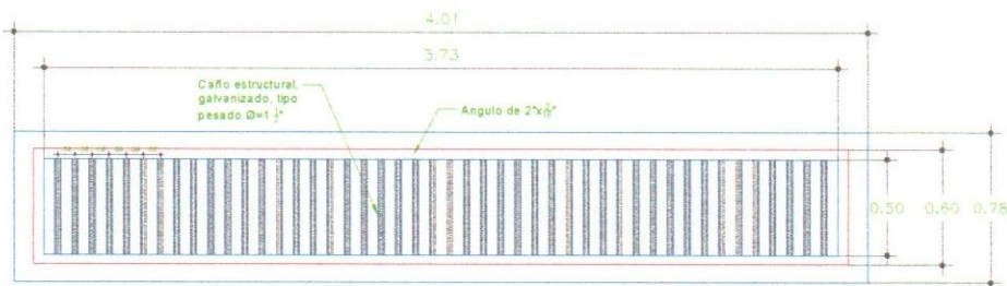
PLANTA DE CANAleta RECOLECTORA DE AGUAS LLUVIAS Y GRISES
