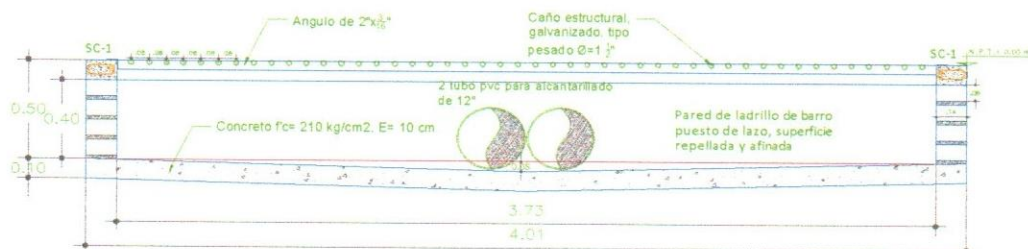
SECCION DE CANAleta RECOLECTORA DE AGUAS LLUVIAS Y GRISES
