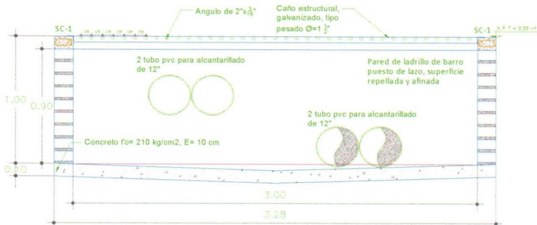
SECCION DE CAJA RECOLECTORA DE AGUAS LLUVIAS_1
